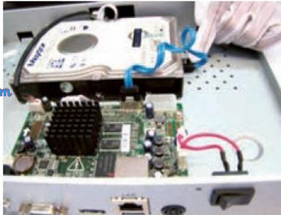
شکل ۳۳- اتصال کابل داده دیسک سخت
