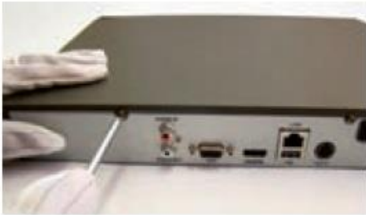
شکل ۳۲- باز کردن درپوش NVR
