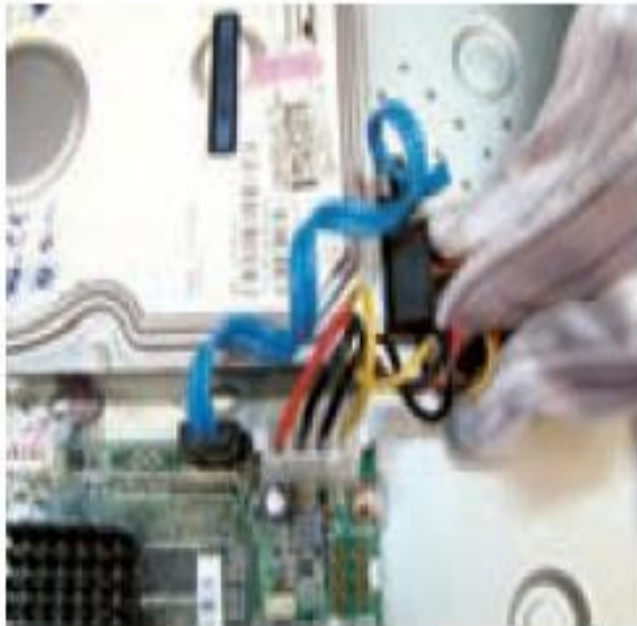
شکل ۳۴- اتصال کابل تغذیه دیسک سخت
