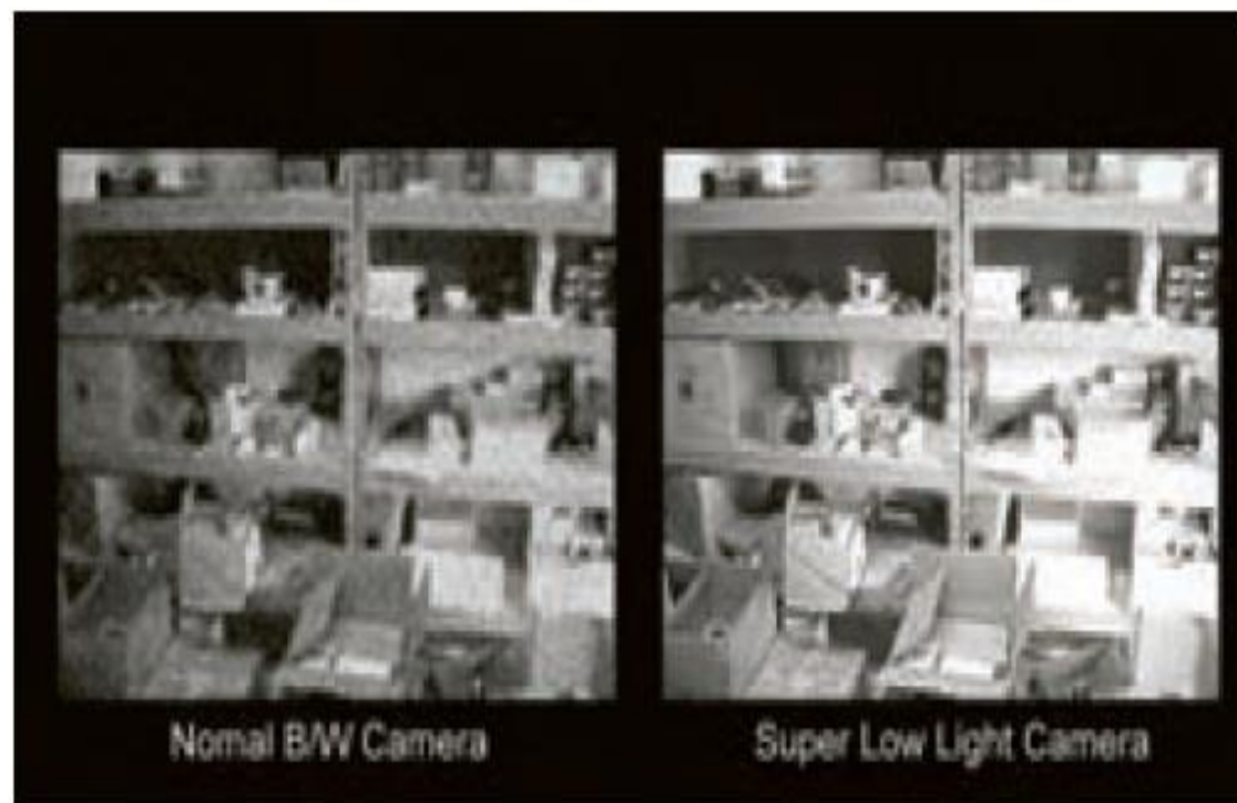
شکل ۱۸- تأثیر مشخصه Minimum Illumination در تصویر
